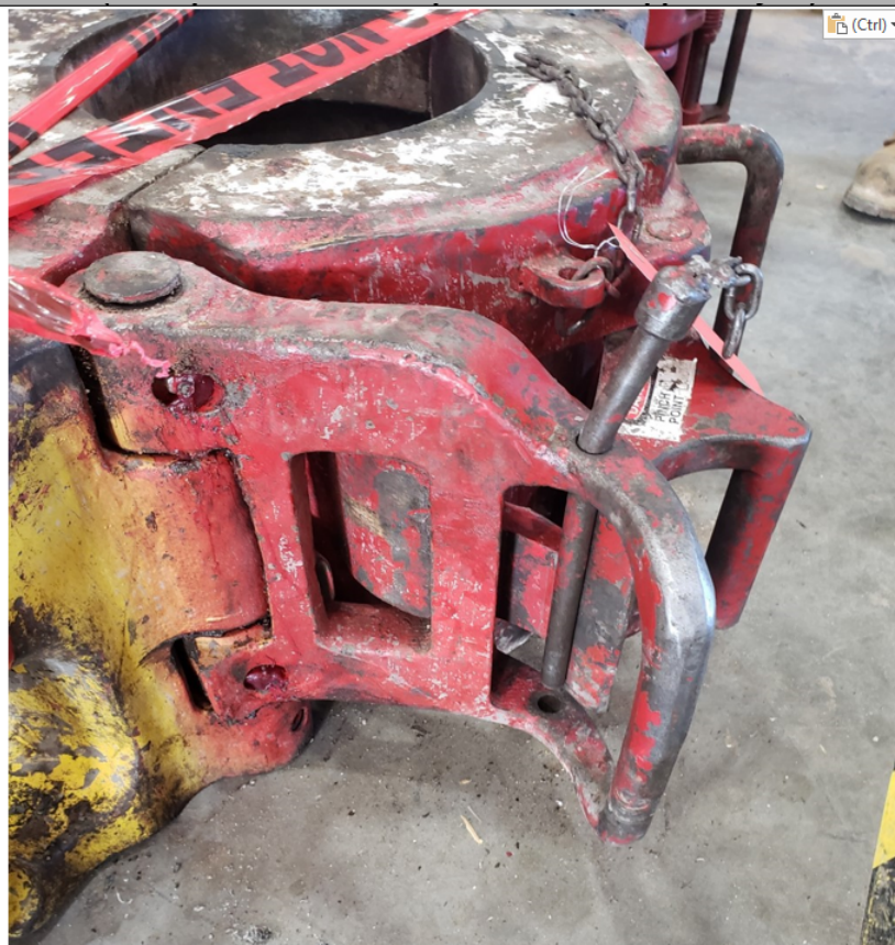
Colocación incorrecta del pin (nota: el pin no fue doblado antes de la caída del objeto)
