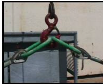
Punto de enganche similar con ángulo de eslinga incorrecto = riesgo
