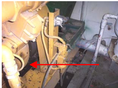
Protector original del ensamble del embrague, que permitía acceso al Volante y al embrague.
