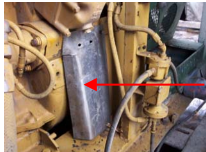
Protector fabricado para eliminar el acceso directo al Volante y embrague expuestos.
